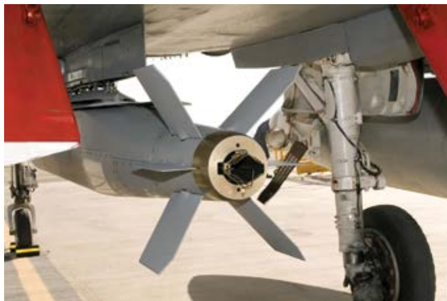
Booster engine on a JSOW
